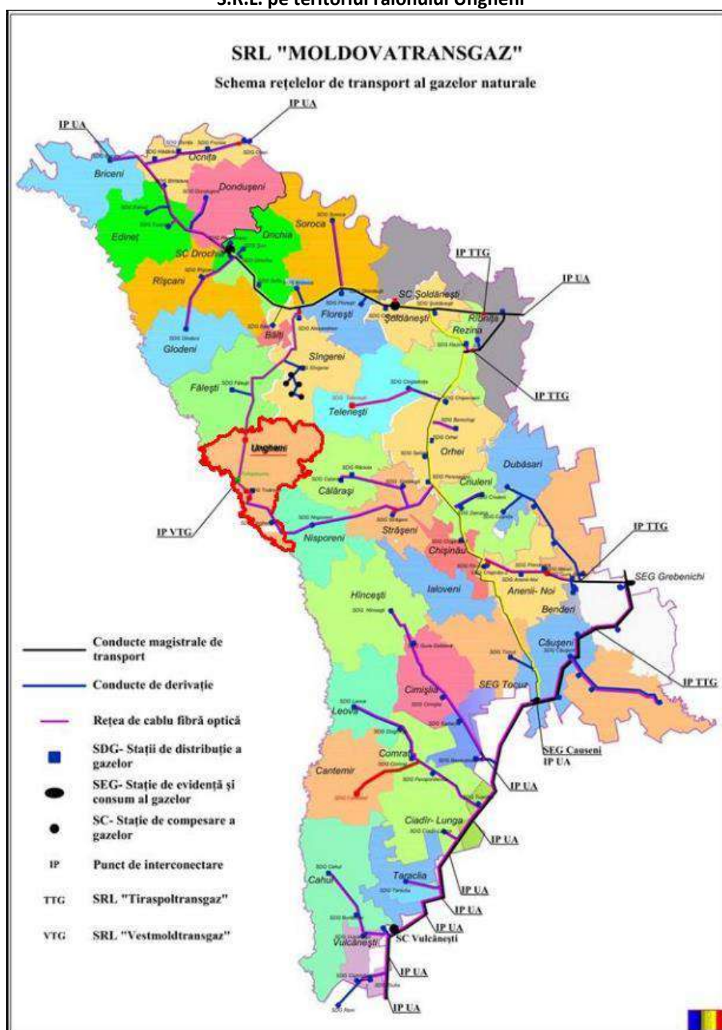
Figura 107: Interconectare sistem gaz a „Vestmoldtransgaz” S.R.L. cu cel a „Moldovatransgaz” S.R.L. pe teritoriul raionului Ungheni
